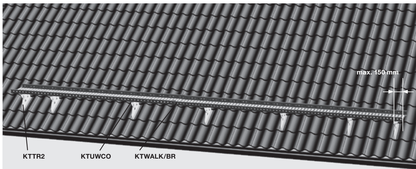
Obr. 15 Montáž střešní lávky na taškovou střechu
